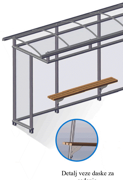
Detalji veza elemenata - nastrešnice autobuskog stajališta
